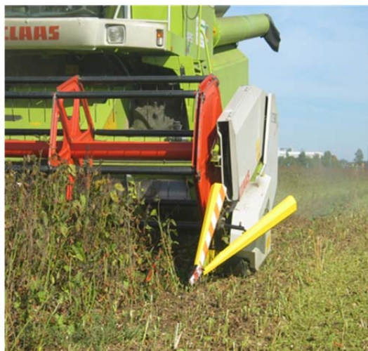
Abb. 28: Um die Hülsen ganz unten zu erwischen, muss das Schneidwerk tief eingestellt werden
